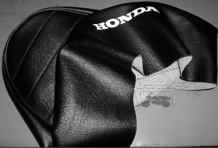
Den neuen Bezug aus der Verpackung nehmen und einige Minuten entfaltet auf der Außenseite des Bezuges legen, ggf. den Sitzbezug mit einem Heißluftfön anwärmen damit die durch Verpackung entstandenen Falten sich lösen.
