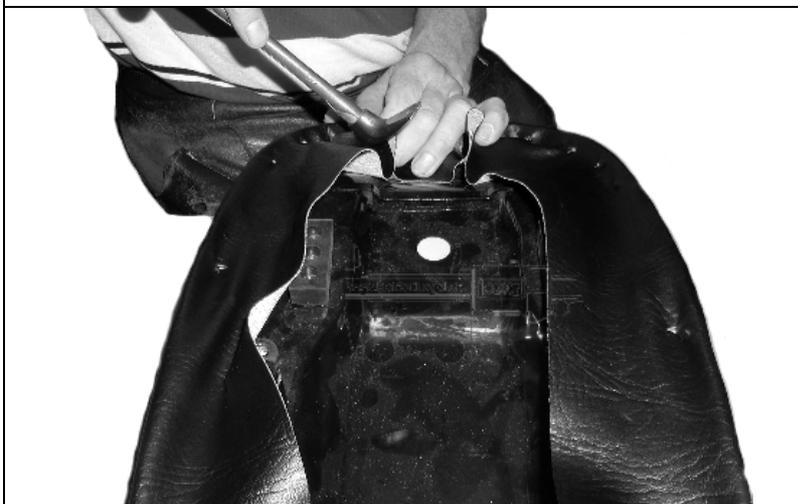
Geht gut mit einen kleine Hammer, aber Achtung! Da sonst der Bezug beschädigt wird.
