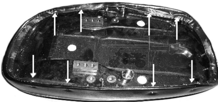
Zuerst muss der alte Bezug runter. Hierzu die spitzen Dreiecke aufbiegen, dass sie im rechten Winkel zum Blech stehen. Falls Nieten vorhanden sind, die Position auf der Trägerplatte markieren. Wenn am Blech nichts zu machen ist, kann jetzt mit dem Beziehen begonnen werden.
