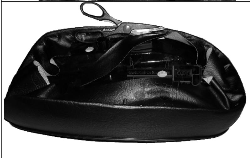
Überstehendes Material des Bezuges mittels einer Schere auf die passende Länge schneiden.
